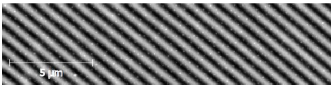
Рис. 5. АСМ изображение поверхности голограммной дифракционной решетки с пространственной частотой 1000 \text{ мм}^{-1} , полученной с использованием многослойных наноструктур \text{Ge}_5\text{As}_{37}\text{S}_{58}\text{-Se} .
