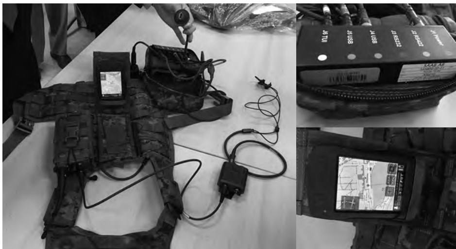
Рис. 2. Коммуникационный комплект командира (Канада), справа хаб от SAAB и планшет
