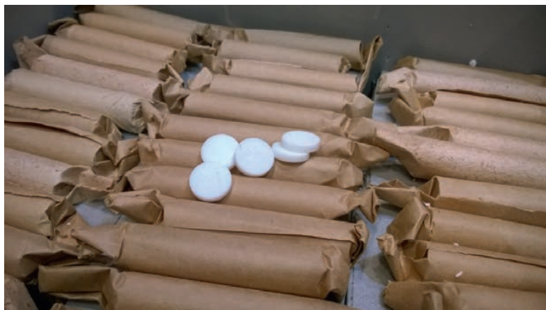
Рис.4. Заготовки, призначені для отримання пористого скла з порами розміром більше 100 нм в упакованому та неупакованому вигляді
