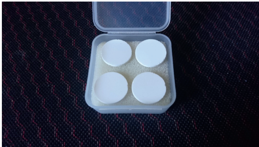
Рис. 5. Несвітлопрозоре пористе скло ПС-1-Ш з макро-порами понад 100 нм, виготовленне способом хімічного травлення заготовок ДВ-1-Ш
