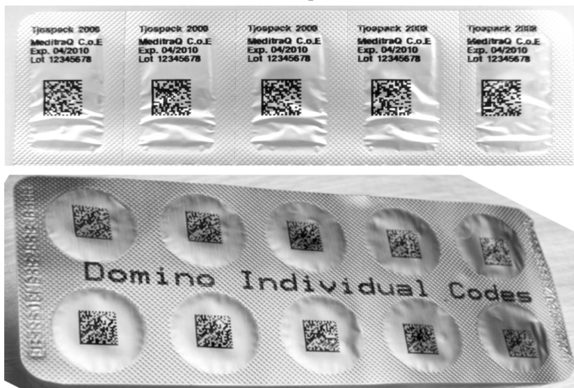
Рис. 1. Маркування 2D кодом стандарту DataMatrixECC 200 окремих таблеток на блистерних упаковках методом серіалізації унікальним кодом (джерело інформації – публікація Walsh Consulting [9]).
