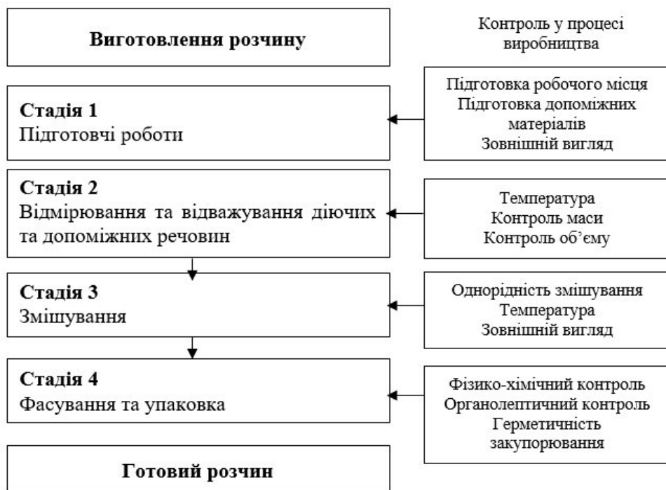
Рис. 3. Технологічна схема виготовлення антисептичних розчинів
