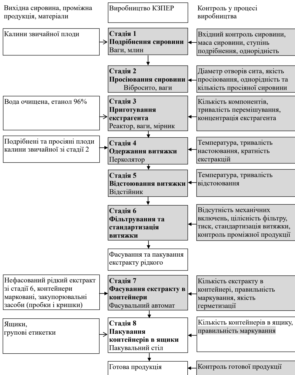
Рис. 1. Технологічна блок-схема виробництва рослинної субстанції калини звичайної плодів екстракту рідкого в промислових умовах
