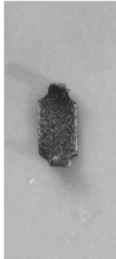
Рис. 5. Титано-нікелева пластина, вкрита композитним матеріалом, видалена через 9 міс. після імплантації, з дрібними фрагментами кісткової тканини на поверхні
