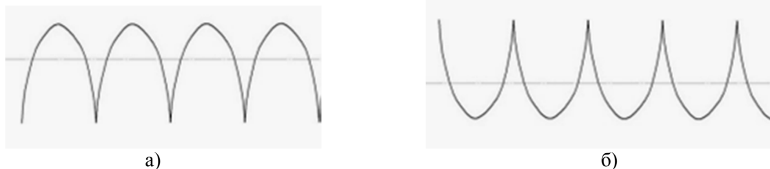
Рис. 2. Профілі двох поверхонь а) та б), які мають однакове значення параметру шорсткості R_a
