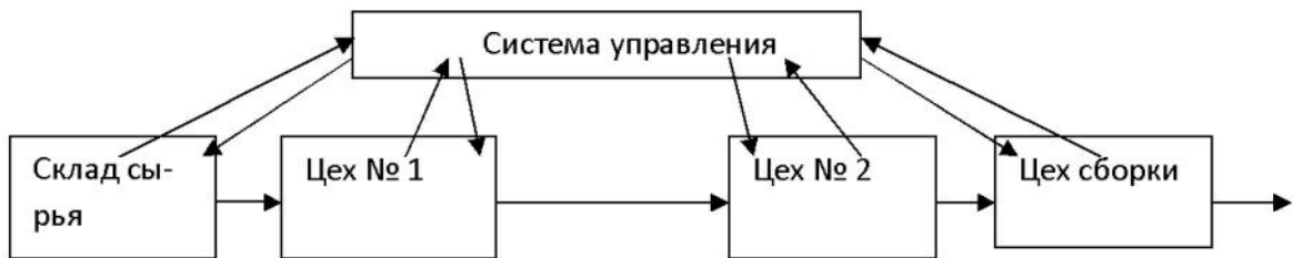
Рис. 1.2 Принципиальная схема, толкающей системы управления материальным потоком в рамках внутрипроизводственной логистической системы
