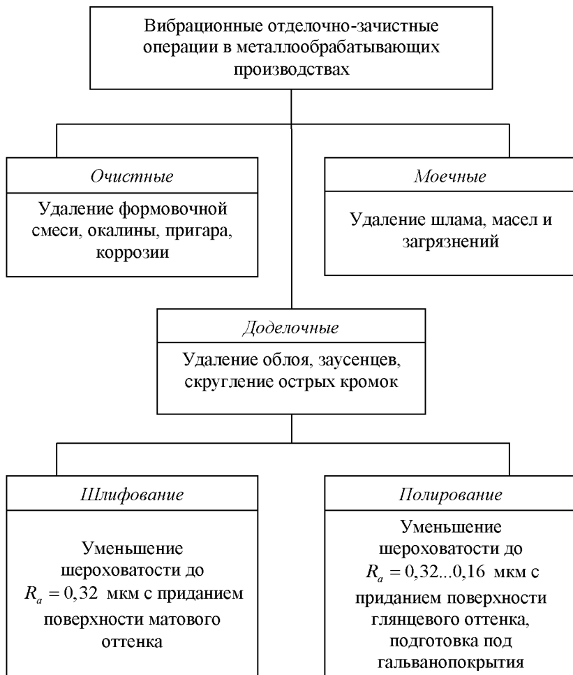
Рисунок 1 – Классификация вибрационных отделочно-зачистных операций, применяемых в металлообрабатывающих производствах
