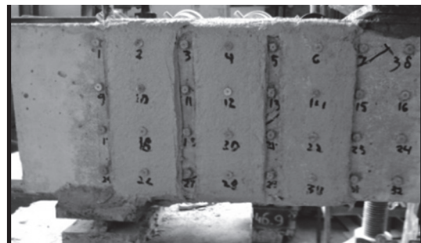
б) загальний вигляд підсиленого похилого перерізу
