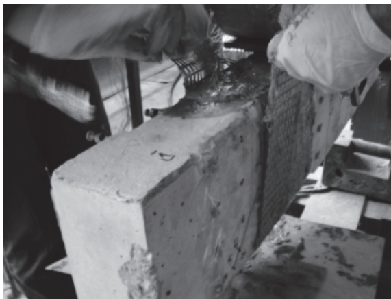
а) нанесення FRCM системи на похилий переріз
