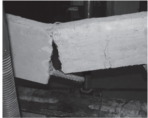
Рис. 3. Характер руйнування дослідних зразків: а) БЗ 2.3; б) БП 2.5-0.3
