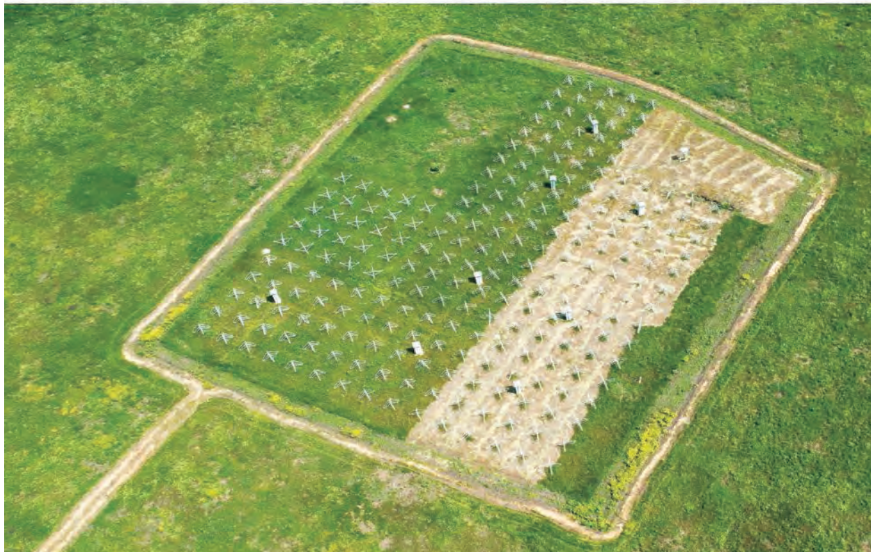
Рис. 23. Радіотелескоп нового покоління ГУРТ (9×25 двополяризованих елементів): зверху – зовнішній вигляд решіток, знизу – вигляд з квадрокоптера
