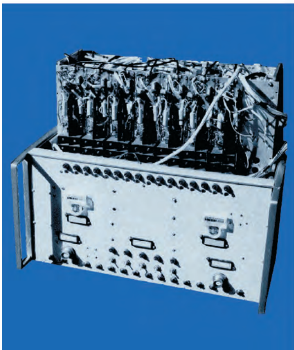
Рис. 32. Аналого-цифровий приймач для досліджень міжпланетних мерехтінгів та швидкоплинних процесів [14]
