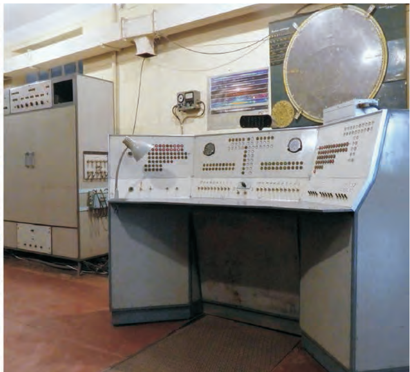
Рис. 13. Пульта управління та оперативного контролю антен Північ–Південь і Схід–Захід поряд із блоком формування променів УТР-2. Ліворуч показана калібрувальна і модуляційна стійка. Після багатьох етапів вдосконалення в ній працює лише генератор калібрувальних сигналів
