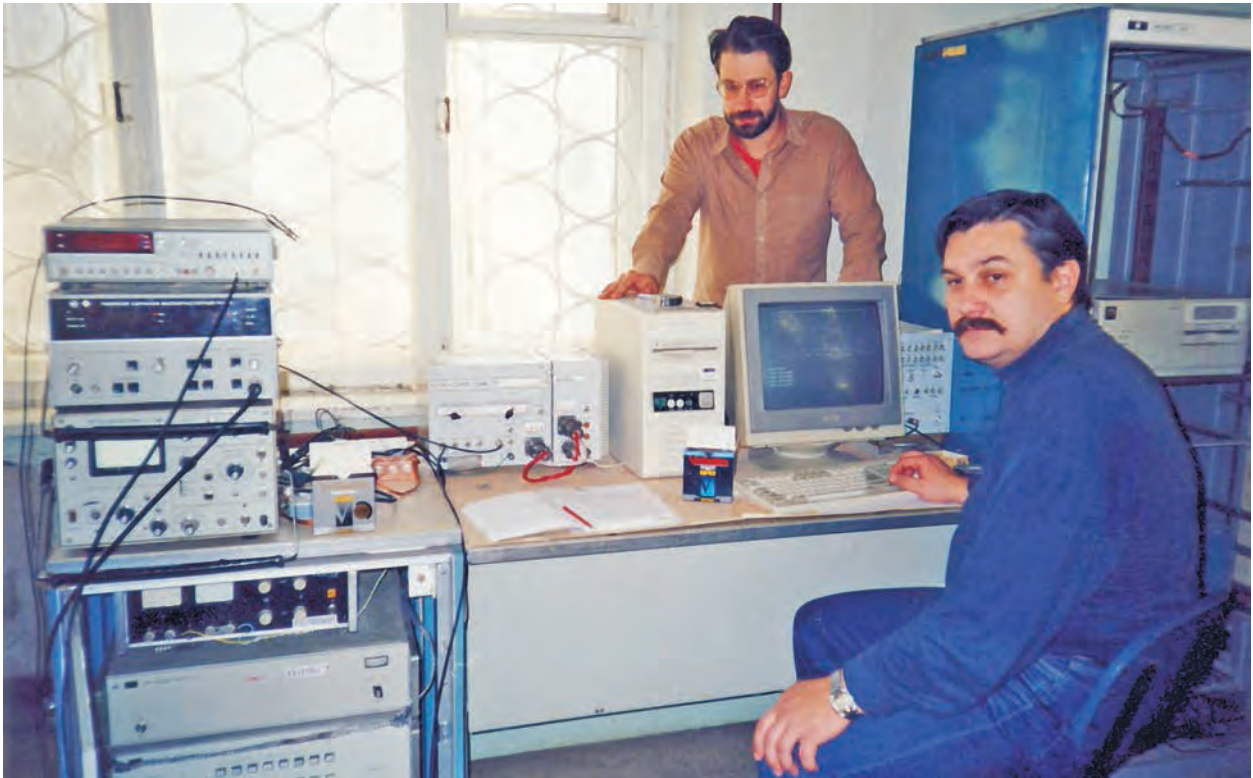
Рис. 31. Д. В. Шалунов (ліворуч) і С. В. Стъопкін за роботою на 4096-каналному цифровому кореляційному спектроаналізаторі [14]
