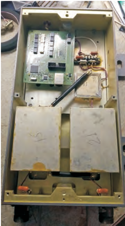
Рис. 11. Антенні підсилювачі нового покоління для однієї смуги частот
