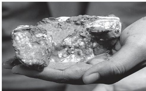
Рис. 5. Брекчиевидная структура газогидратной залежи. Образец со дна оз. Байкал (фото Российского географического общества)
