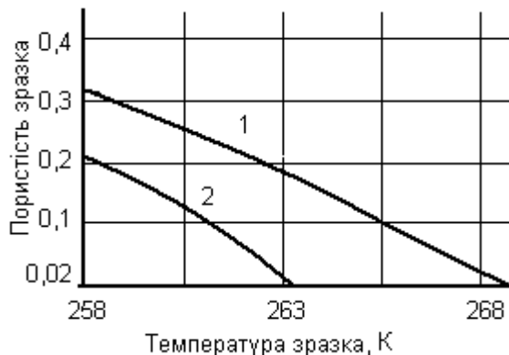
Рисунок 2 – Графіки залежності температури газогідрату від пористості для прояву ефекту самоконсервації при атмосферному тиску і температурі повітря 273 К (крива 1) та 278 К (крива 2)
