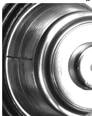
а – комплекти №1, №2, №3 (з ліва на право) секцій дослідного долота, б – цапфа лапи у навантаженій ділянці (комплект №3), в – характер зносу антифрикційної втулки в порожнині шарошки (комплект №3), г – темплет для встановлення якості наплавлення і зміцнення ділянки великого підшипника ковзання і бігової доріжки замкового кулькового підшипника кочення цапфи лапи
