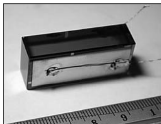
Рис. 1. Зразок монокристала ZnSe для вимірювання гамма-випромінювання
