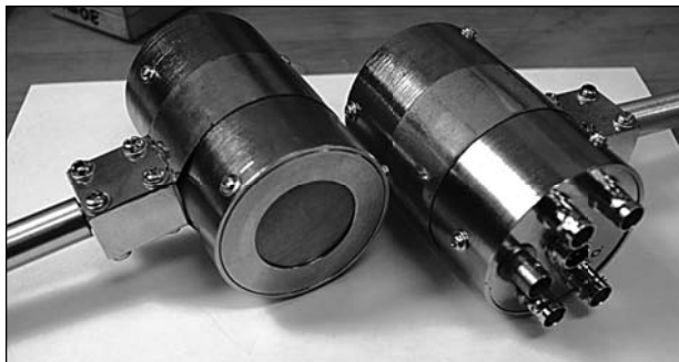
Рис. 5. Зовнішній вигляд вхідного блока детектора іонізуючого випромінювання із вхідним захисним вікном
