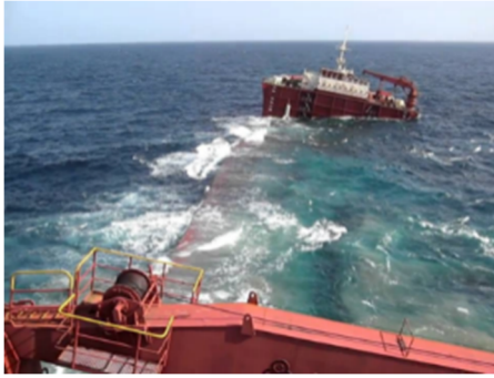
Рис. 5 Втрата остійності судном «MV Transporter»
