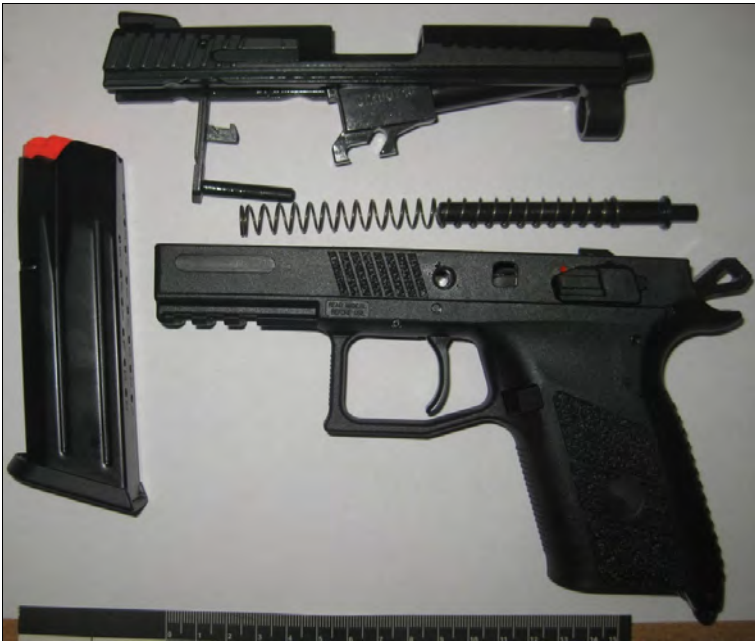
Рис. 3. Частина пістолета «T-REX» після неповного розбирання
