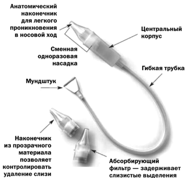
Устройство аспиратора «Отривин Бэби»
