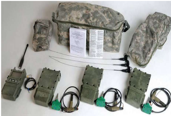
Рисунок 2 – Сенсорна система виявлення вторгнень на полі бою AN/PRS-9A BAIS
