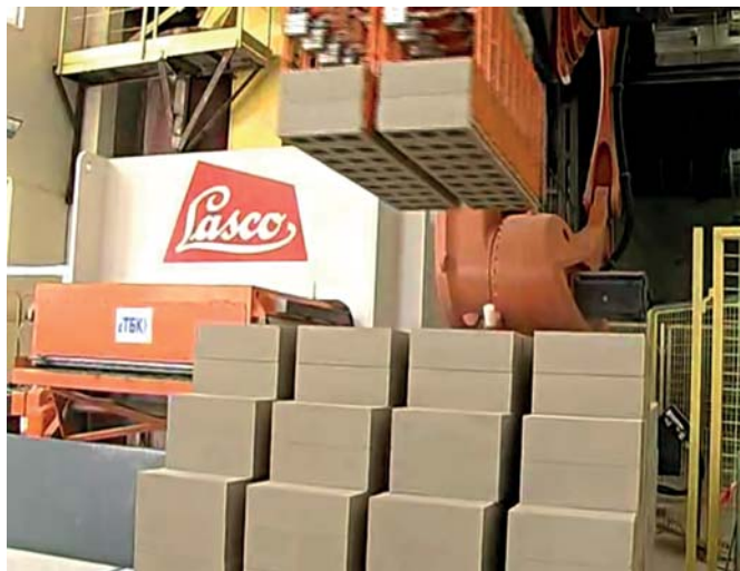
Рис. 2. Полностью автоматизированный комплекс Lasco-Eirich по производству кирпичей и камней в работе.
