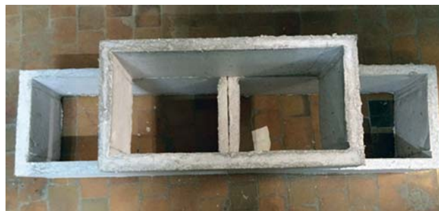
Рис. 5. Фрагмент кладки блоков
