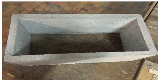
Рис. 4. Блок несъемной опалубки стен из магниезного вяжущего
