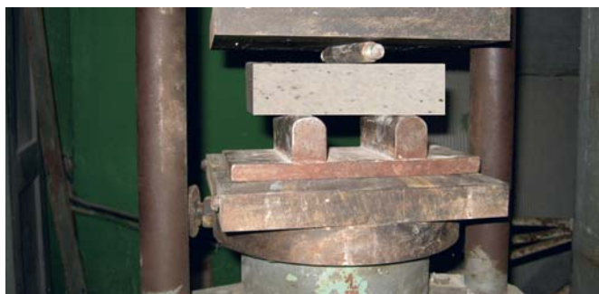
Рис. 1. Испытание прочности балочки на изгиб
