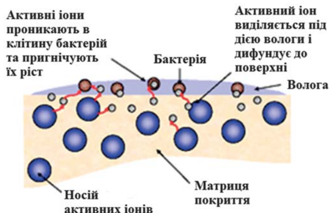
Рис. 15. Схематичне зображення процесів, які проходять на антимікробних покриттях
