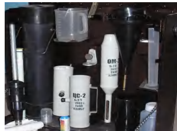
Рис.3. Полевая лаборатория контроля параметров бурового раствора
