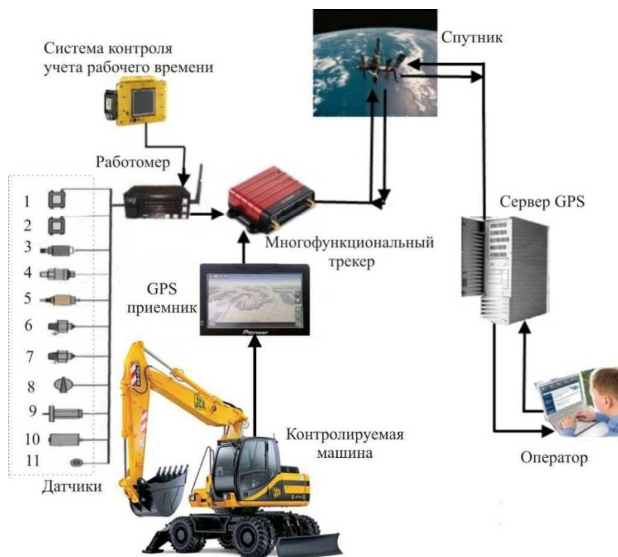
Рис. 1. Контроль оператора за работой машины в режиме реального времени с помощью GPS; 1 – датчик поворота платформы; 2 – датчик количества расходуемого топлива; 3 – датчик объема перемещаемого грунта ковшом; 4 – датчик массы переносимого грунта; 4 – датчик скорости экскаватора; 5 – датчик режима работы двигателя; 6 – датчик поворота платформы; 7 – датчик контроля усталости машиниста; 8 – датчик давления масла в гидросистеме; 9 – датчик учета количества рабочих циклов; 10 – датчик типа модуля технологической оснастки рабочего органа; 11 – датчик контроля устойчивости экскаватора.
