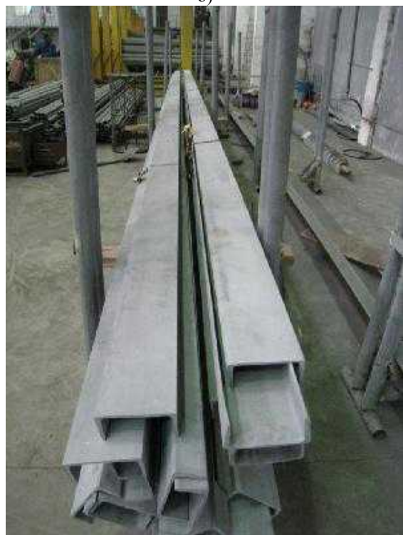
Рис.6. Внешний вид металлоизделий с диффузионным цинковым покрытием: а). крепежные изделия. б). оцинкованные элементы строительных конструкций в). оцинкованный строительный профиль / Appearance of metal products with diffusion zinc coatings: fasteners; zined elements of building structures; zined building profile
