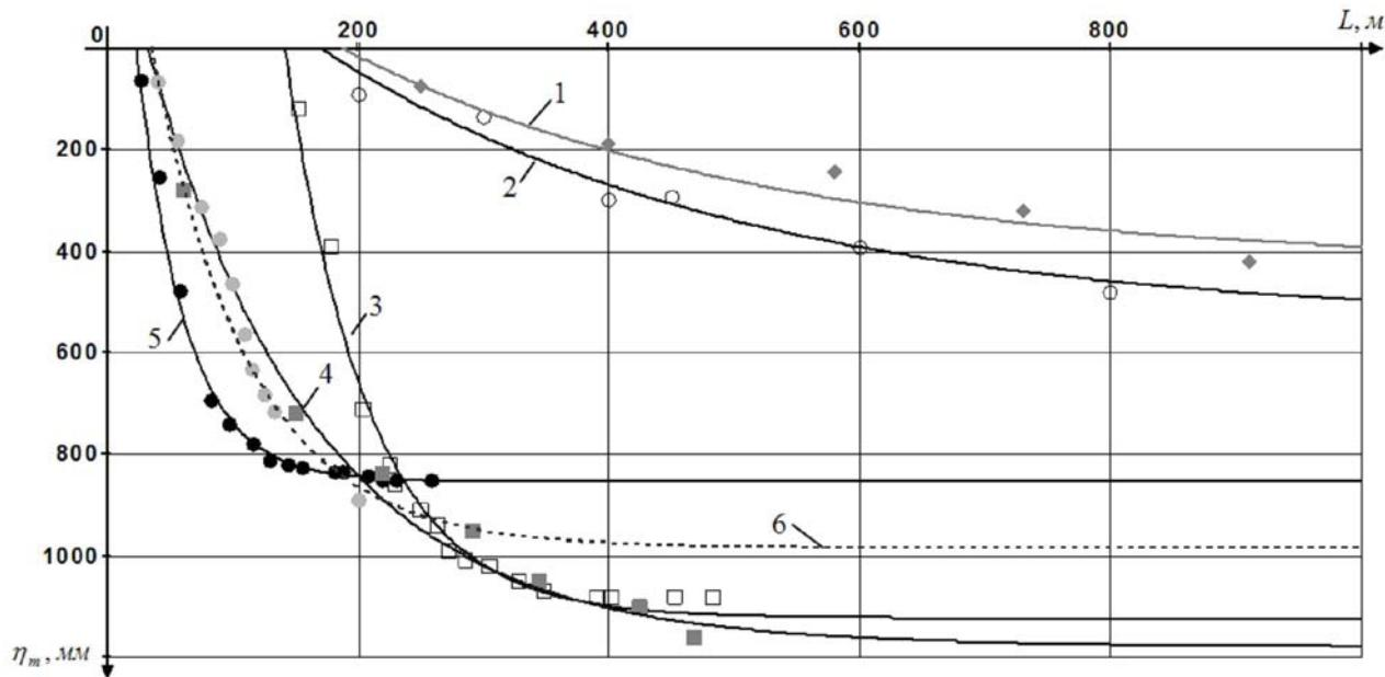
◆, ○, □, ■, ●, ● - экспериментальные данные максимальных оседаний земной поверхности соответственно в условиях шахт им. М.В.Фрунзе (пласт  $h_8$ ) [3], им. П.Л. Войкова (пласт  $k_5^1$ ) [4], одной из польских шахт [5], им. Г.Г. Капустина (пласт  $m_3^H$ ) [6], «Степной» (пласт  $C_6$ ) [7], «Юбилейной», пласт  $C'_6$  [8];
