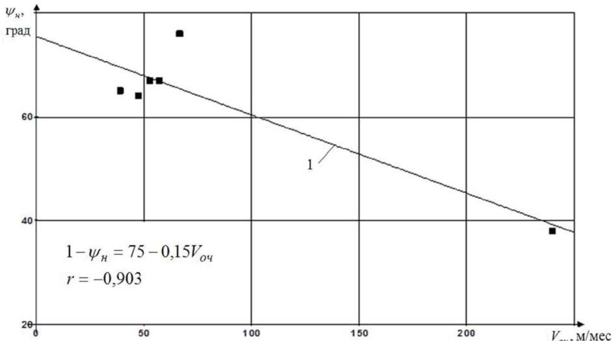
■ – расчетные значения угла  $\psi_h$ , соответствующие началу сдвига точки на земной поверхности;
