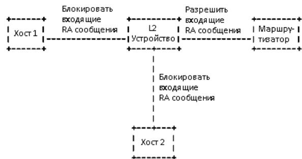
Рис. 3. Принцип работы RA Guard
