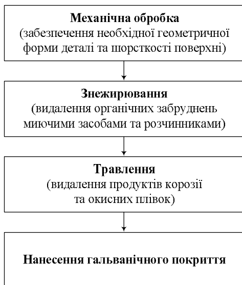
Рис. 1. Етапи підготовки деталей до формування електролітичних покриттів
