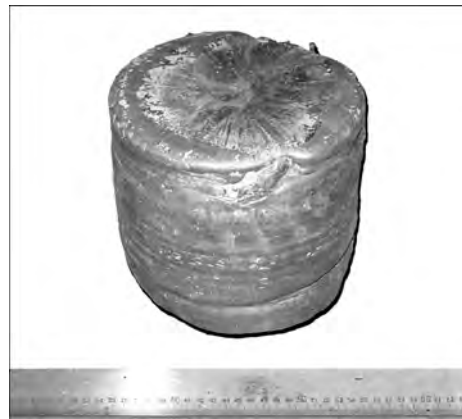
Рис. 3. Слиток, выплавленный из скомпактированной стружки прохождении тока, разупрочняется. В этот момент происходит сдавливание пуансоном стружки до минимального объема. Длительность компактирования одной порции составляет 25 с. Затем загружается следующая порция стружки и процесс повторяется.
