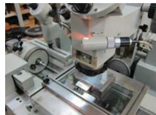
Рис. 3. Вимірювання розмірів конусів експериментальної металеві моделі «Еталон 2» за допомогою універсального вимірювального мікроскопа УИМ-21.
