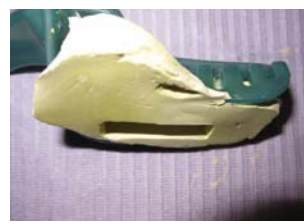
Рис. 4. Деформовані відбитки, отримані з альгінатного матеріалу Tropicalgin, (зліва) після тривалого занурення в розчин «Ізумруд» (24 години); (справа) після впливу НВЧ-дезінфекції (звичайний режим – час експозиції 10 хв, потужність 100% (850Вт).
