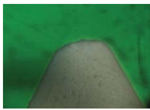
Рис. 5. Збільшені за допомогою універсального мікроскопа верхівки гіпсових конусів. (Зліва) виготовлені за деформованим відбитком, (справа) виготовлені за відбитком без відчутних змін.
