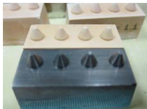
Рис. 2. Гіпсові моделі для вимірювання змін геометричних параметрів, виготовлені за відбитками, отриманими альгінатним матеріалом Tropicalgin.
