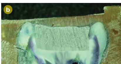
Рис. 9. Прямі реставрації з амальгами без адгезиву: а – відсутність крайового проникнення барвника на межі «тверді тканини–пломба»; б – проникнення барвника вздовж краю на половину глибини порожнини; с – проникнення барвника до дна порожнини й навколо всієї пломби, включаючи дно.
