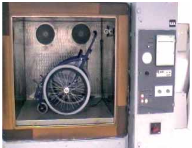
Рис. 5. Камера для визначення стійкості до дії кліматичних факторів згідно з ДСТУ ISO 7176-8
