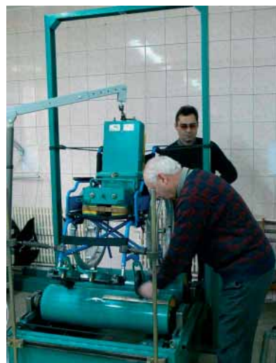
Рис. 7. Стэнд для проведення випробувань на утомну міцність (двовалковий випробувальний стэнд), розроблений згідно з ДСТУ ISO 7176-8
