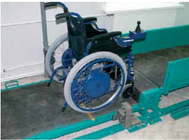
Рис. 4. Стэнд для визначення можливості подолання перешкоди для крісел колісних з електричним приводом, розроблений згідно з ДСТУ ISO 7176-10
