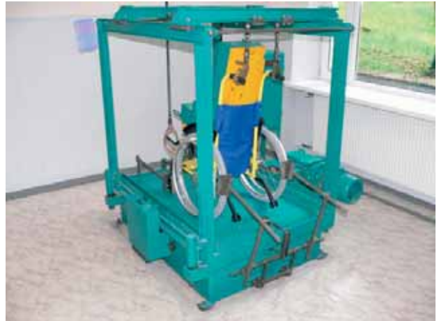
Рис. 3. Стэнд для проведення випробувань на утомну міцність при падінні з висоти 50 мм, розроблений згідно з ДСТУ ISO 7176-8
