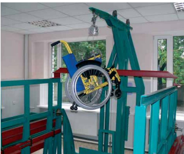
Рис. 6. Пристрій для випробувань на ударну міцність при падінні з висоти 1 м у складеному стані, розроблений згідно з ДСТУ ISO 7176-8
