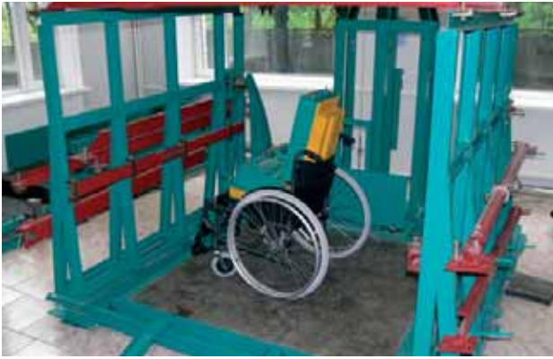
Рис. 2. Універсальний стэнд для проведення випробувань на статичну та ударну міцність, а також визначення статичної стійкості й ефективності гальмівної системи, розроблений згідно з ДСТУ ISO 7176-8
