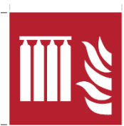
Батарея балонів стаціонарної системи пожежогасіння
