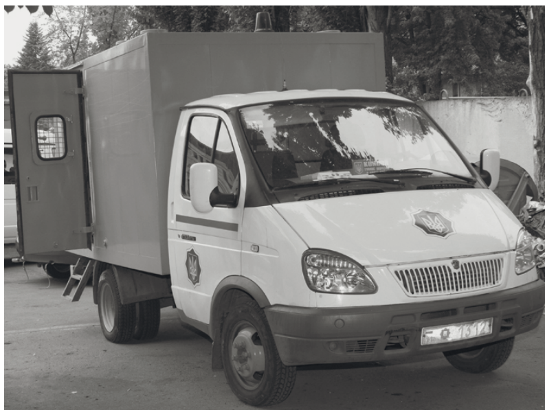
Рис. 8. Спеціалізований автомобіль для перевезення осіб, взятих під варту, на базі автомобіля ГАЗ-3302 “Газель”.
