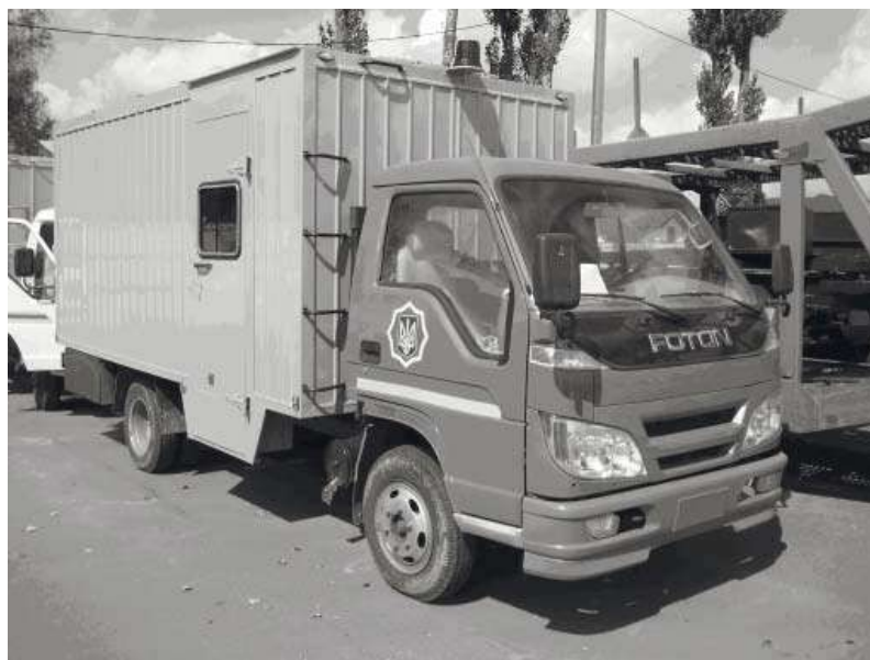
Рис. 10. Спеціалізований автомобіль для перевезення осіб, взятих під варту на базі Foton VJ-1043.
