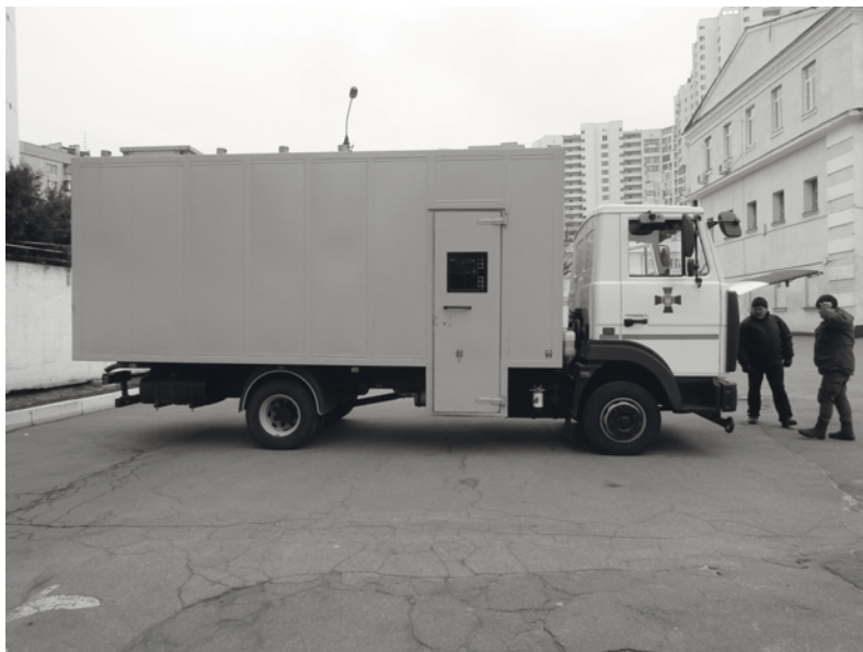
Рис. 19. Спеціалізований автомобіль для перевезення осіб, взятих під варту, на базі МАЗ-4370.
