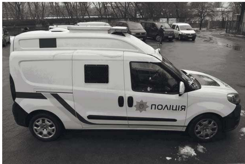
Рис. 16. Спеціалізований автомобіль для перевезення осіб, взятих під варту, на базі FIAT Doblo.
