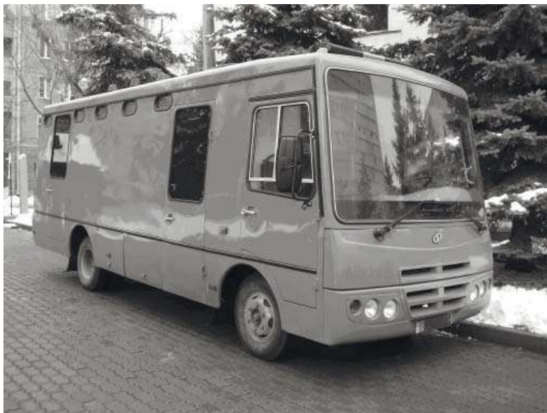
Рис. 14. Спеціалізований автобус для перевезення осіб, взятих під варту, на базі автобуса ХАЗ-3250.
