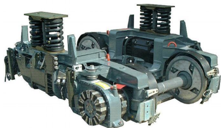
Рис. 5. Візок низковольтного трамвайного вагона Flexx Urban 1000 фірми Bombardier
