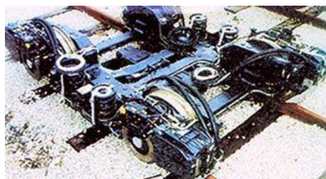
Рис. 6. Моторна візок трамвайного вагона АТ 6/5 L
