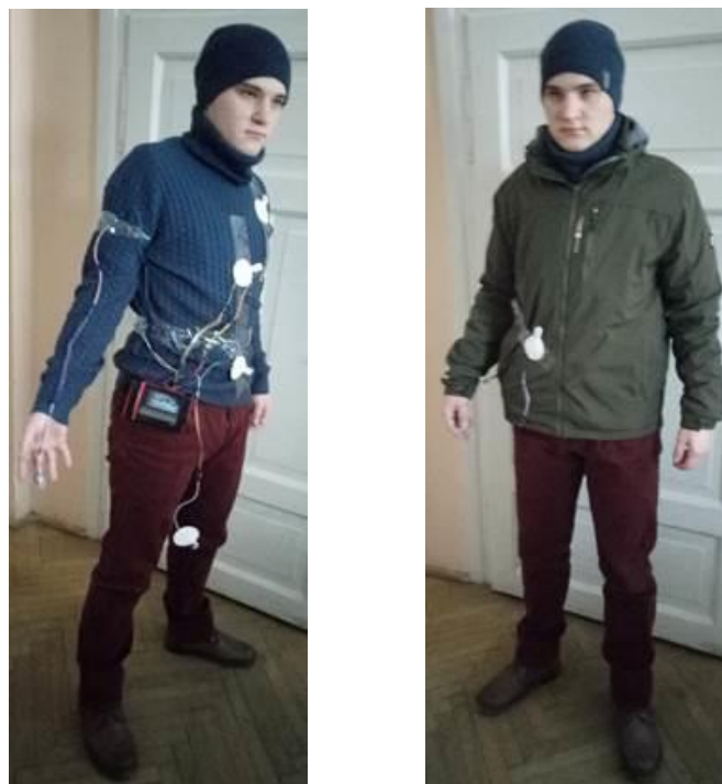
Рис. 2. Розміщення датчиків на тілі людини: 1 – датчик температури і вологості нижньої частини одягу; 2 – датчик температури і вологості середньої частини одягу; 3 – датчик температури і вологості верхньої частини одягу; 4, 5, 6 – датчики температури і вологості зворотньої частини тулуба людини; 7 – датчик пульсу серцебиття; 8 – датчик температури і вологості довкілля
