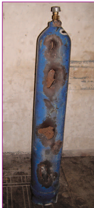
Фото 3. Повреждённый взрывом пустой баллон. Вмятины и выбоины образовались от осколков взорвавшихся баллонов
