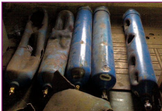
Фото 1. Повреждённые пустые баллоны, которые находились в контейнере в момент взрыва. На переднем плане — остатки полного баллона, разрушение которого вызвало новый взрыв
