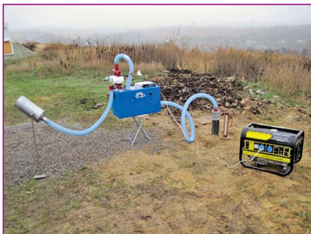
Фото 2. Мобильная аппаратура для исследования скважин биогаза
