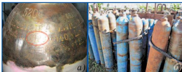
**Фото 1.** Состояние газобаллонного хозяйства некоторых компаний в СНГ: а — бывший в употреблении баллон, изготовленный в 1920 г. и использовавшийся в Беларуси; б — стандартные постсоветские паллеты с 40-литровыми баллонами в России
