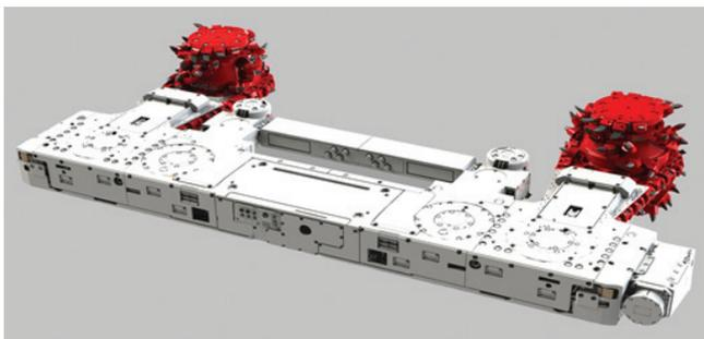
Рис. 2. Очистной комбайн КА200.
