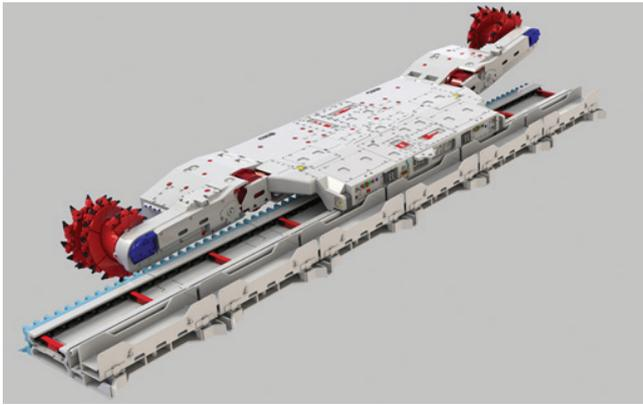
Рис. 4. Очистной комбайн УКД400.
