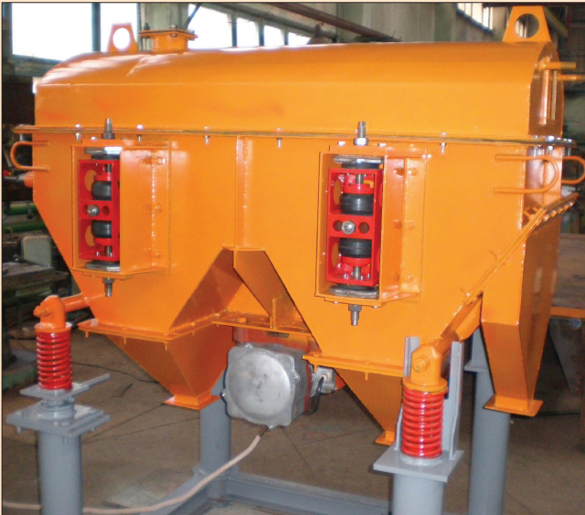
Рис. 1. Вибрационный поличастотный грохот MBV1.0 для тонкого разделения.
