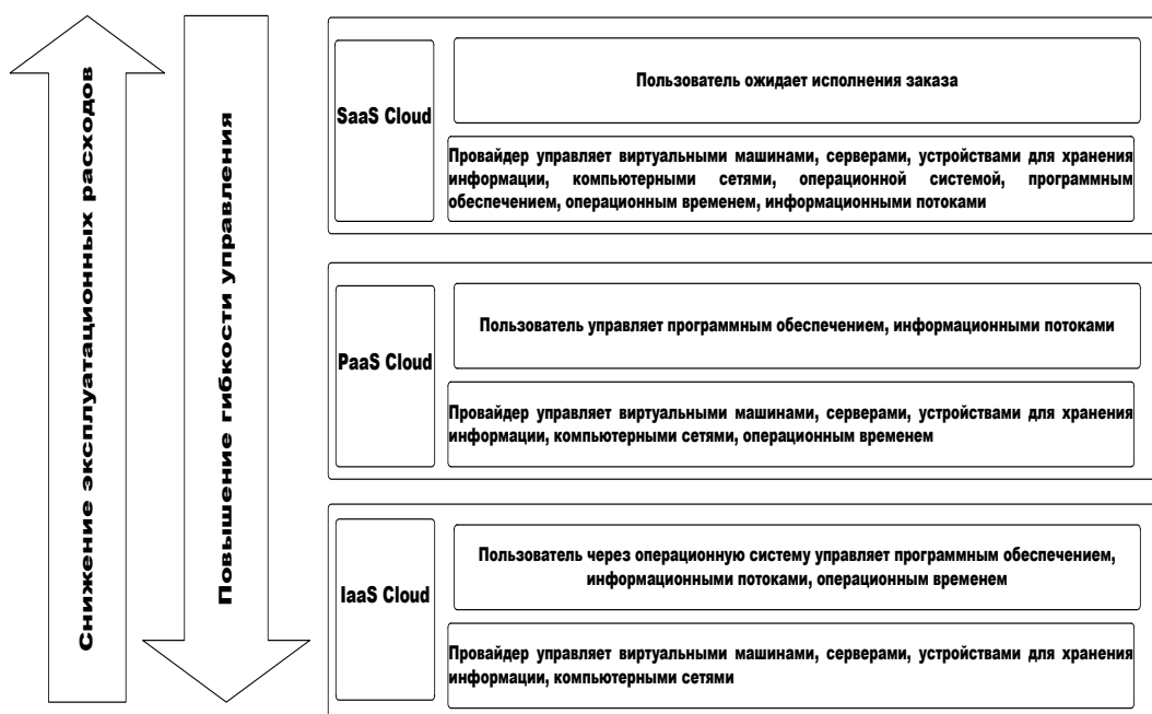
Рис. 1. Схема функционального применения компонентных составляющих облачной инфраструктуры
