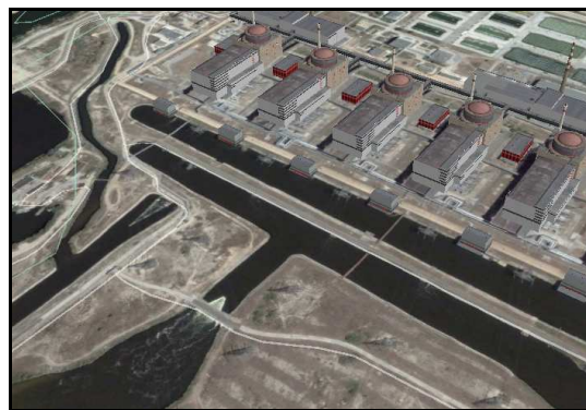
Рис. 1 - Сброс подогретой воды в пруд-охладитель ЗАЭС
