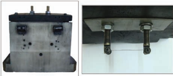
Рисунок 1 – Разрядная камера и электродная система с заданным межэлектродным промежутком для ЭВ металлических проводников
