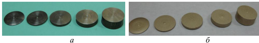
Рис. 2 – Образцы из латуни ЛС59.1 в форме диска диаметром 20 мм и толщиной 0,5; 1; 2; 4 и 8 мм: а – до обработки; б – после обработки
