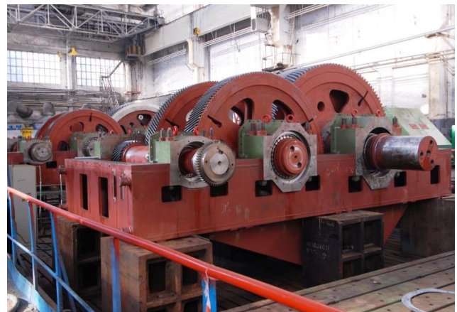
Рис. 5 – Важкий 3-осний редуктор з зубчастими передачами виготовлений по інноваційній технології
