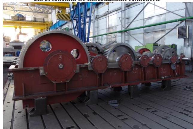
Рис. 6 – Важкий 6-осовий редуктор з зубчастими передачами виготовлений за інноваційній технології
