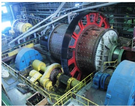
Рис. 1 – Рудорозмельний млин з зубчастими передачами виготовлений по інноваційній технології
