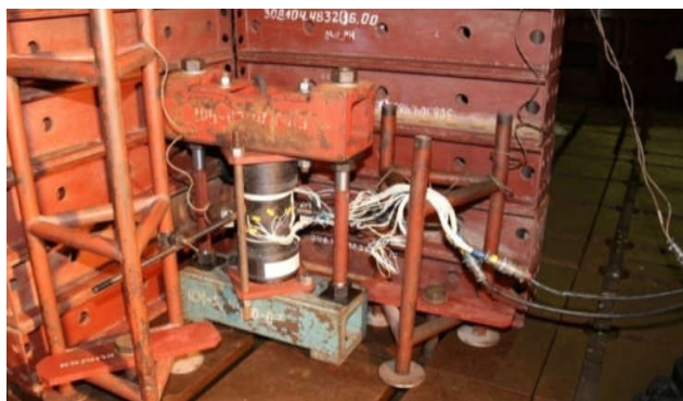
Рис. 1. Подсоединение высоконапорной водяной установки к трубчатой модели
