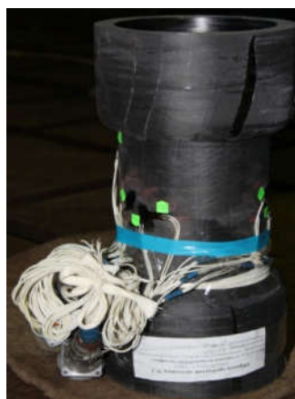
Рис. 2. Модель с тензодатчиками
