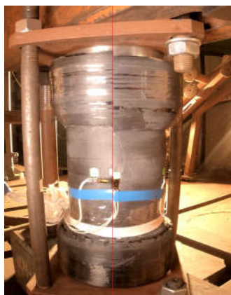
Рис. 4. Визуальное представление деформации макета под действием внутреннего давления
