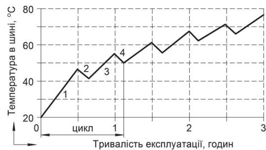
Рис. 5. Показник ТКнГ і температура в шині: 1 – рух навантаженої машини; 2 – розвантаження; 3 – рух порожньої машини; 4 – завантаження
